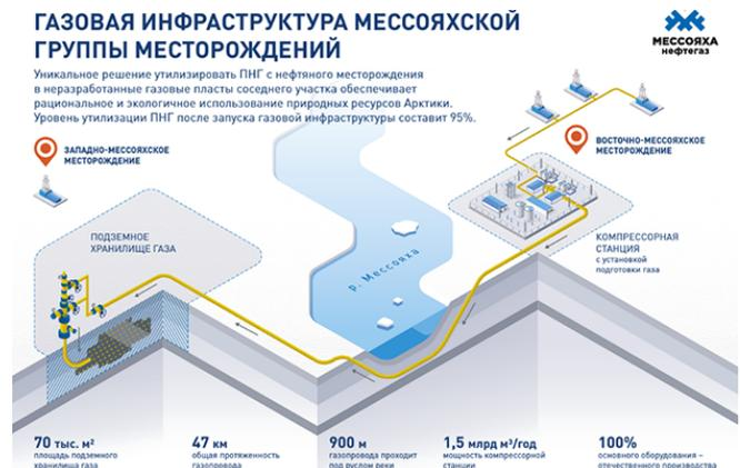
Рисунок 2 – Схема проекта утилизации ПНГ АО «Мессояханефтегаз»
